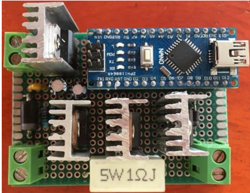
Hình 3.26: Mạch thu hồi năng lượng điện cảm và điều khiển kim phun
