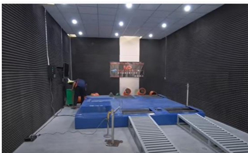
Hình 4.9: Băng thử công suất và hệ thống truy xuất dữ liệu
